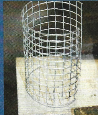
Gaas van 4 mm. De hoogte van de korf kun je variëren.
