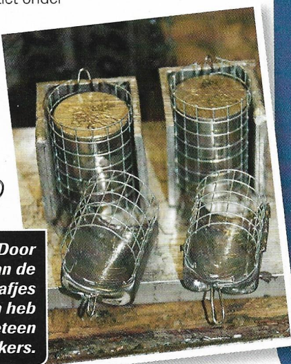
Plaats aan de achterzijde het rvs staafje, wat nadien dienst doet als bevestigingssoog.
